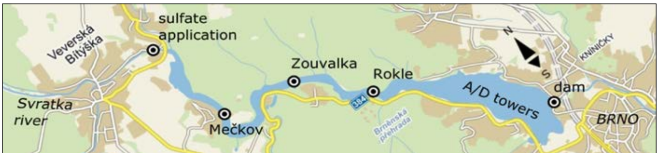
Abb. 10. Schema der Talsperre mit markierten Entnahmeprofilen, der Fällungsstelle sowie dem Bereich mit Belüftungs- und Destratifizierungstürmen.
