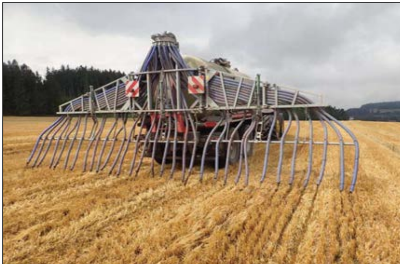
Obr. 5. Aplikace kejdy skotu hadicovým aplikátorem, poté je nutné rychlé zapravení kejdy do půdy Abb. 5. Ausbringung von Rindviehgülle mit Schleppschläuchen, danach ist eine schnelle Gülleinarbeitung in den Boden notwendig
